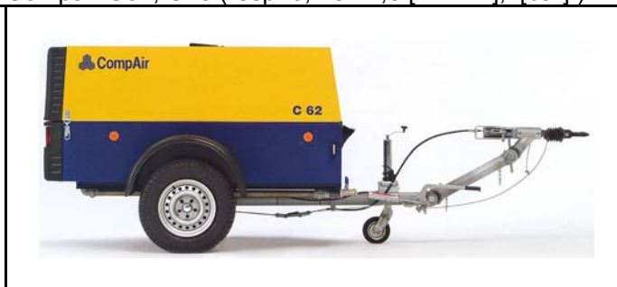
Compair C62, C76 (resp. 6,2 en 7,6 [m 3 /min], 7[bar] )
